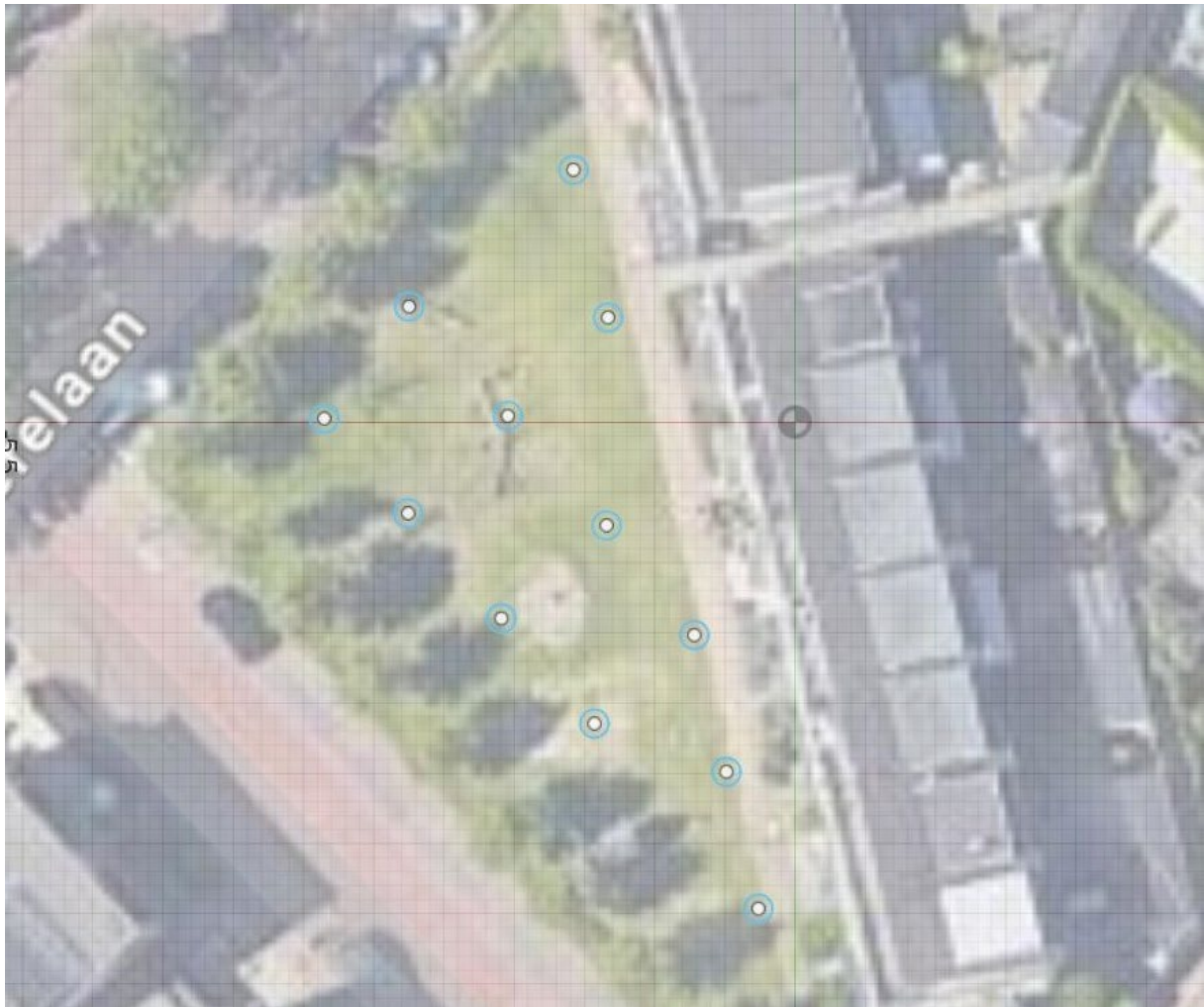
Figuur 37: Boorgrid voor gesloten bodemlussen. (Bron: Indurio)
